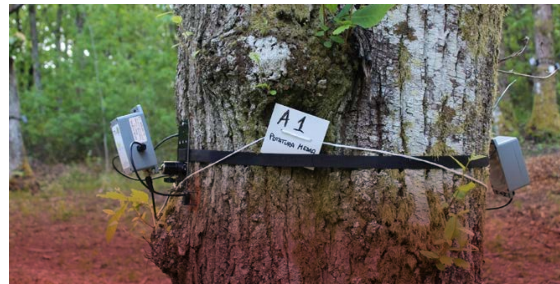
Castagneto didattico sperimentale di Granaglione, monitoraggio con sensoristica Tree Talker®Cyber
